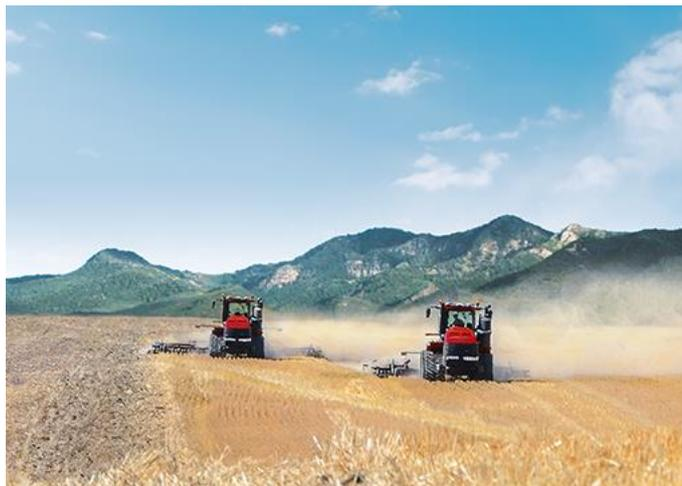
*Didascalìa: L'autonomia con supervisione, una delle cinque categorie di automazione definite da Case IH, consente all'operatore di un trattore di sorvegliare il funzionamento di un altro trattore, privo di operatore, che lavora nello stesso campo.*
